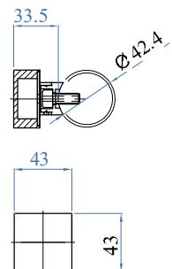
Forma cilindrica Ø 42,4 mm
